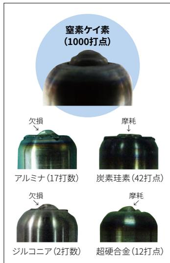
摩擦攪拌接合ツールは、高温下での耐摩耗性が要求されます。窒化ケイ素は他素材に比べ、耐摩耗性に優れています。
