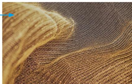
素材の引張強度が大きいこと、細線に加工できること、編み加工性が良いことから、モリブデンがアンテナ材として採用されました。
